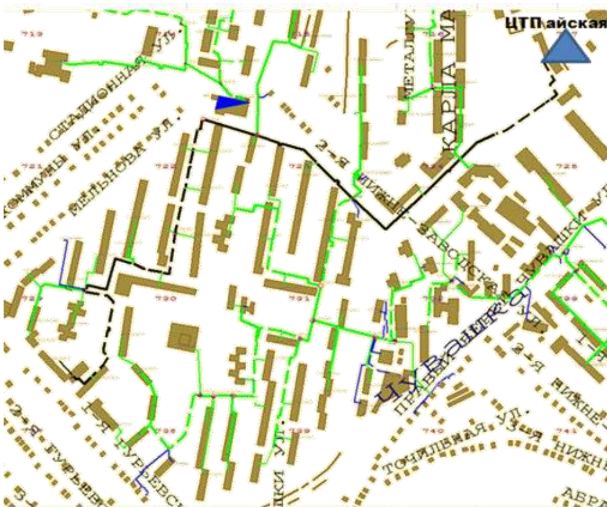
Рисунок 1.50 Пути для расчёта вероятности безотказной работы тепловых сетей котельной ЦЭС от ЦТП-айская до дома № 23 2-го Северо-западного квартала
