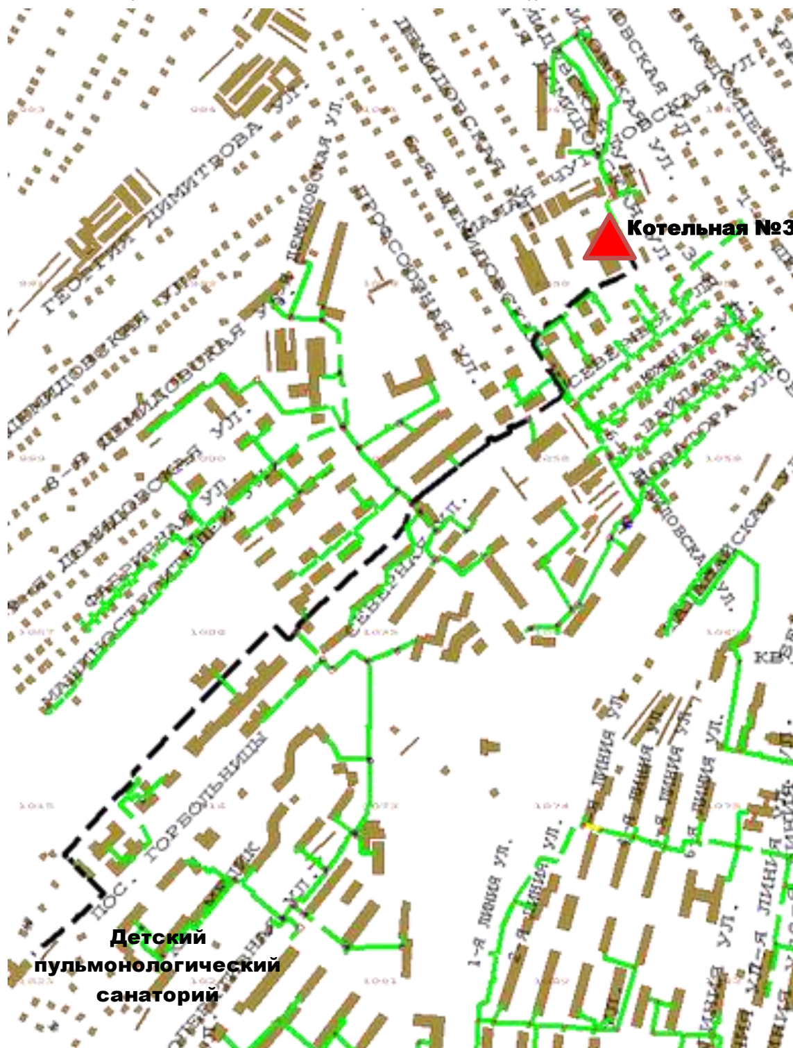
Рисунок 1.11 Пути для расчёта вероятности безотказной работы тепловых сетей от котельной № 3
