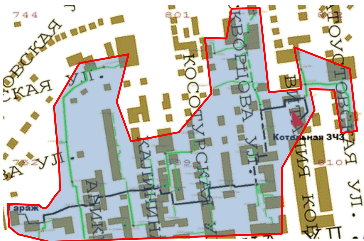
Рисунок 1.32 Путь для расчёта вероятности безотказной работы тепловых сетей от котельной ЗЧЗ
