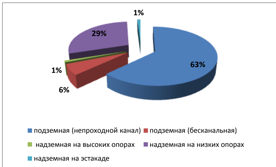
Рисунок 3.2 Доли протяженности участков трубопроводов тепловых сетей от ТЭЦ ОАО «Златмаш» различных видов прокладки
