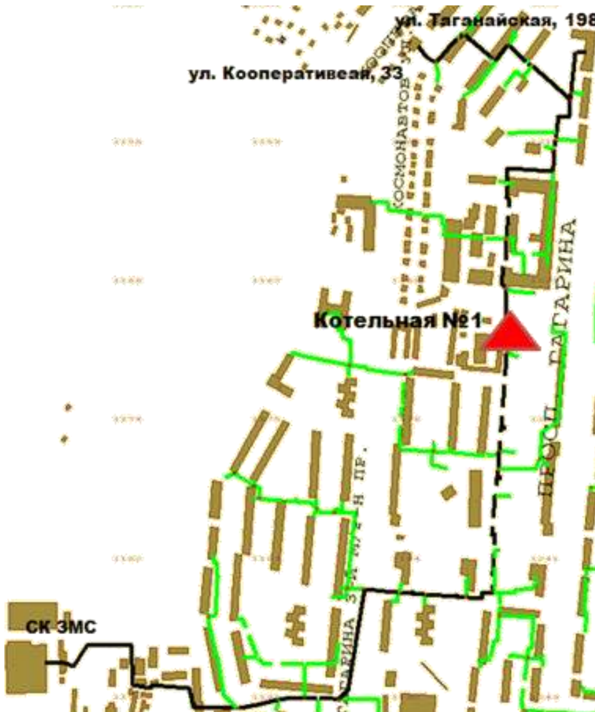
Рисунок 1.2 Пути для расчёта вероятности безотказной работы тепловых сетей от котельной № 1
