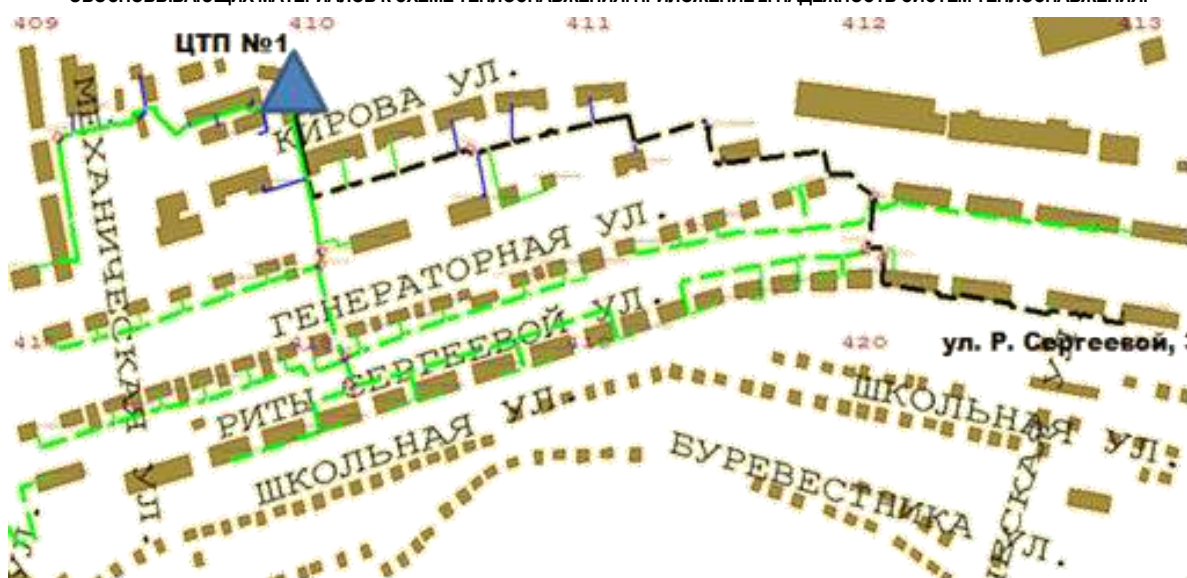
Рисунок 1.38 Пути для расчёта вероятности безотказной работы тепловых сетей котельной ЦЭС от ЦТП-1 до дома № 3 по улице Р.Сергеевой
