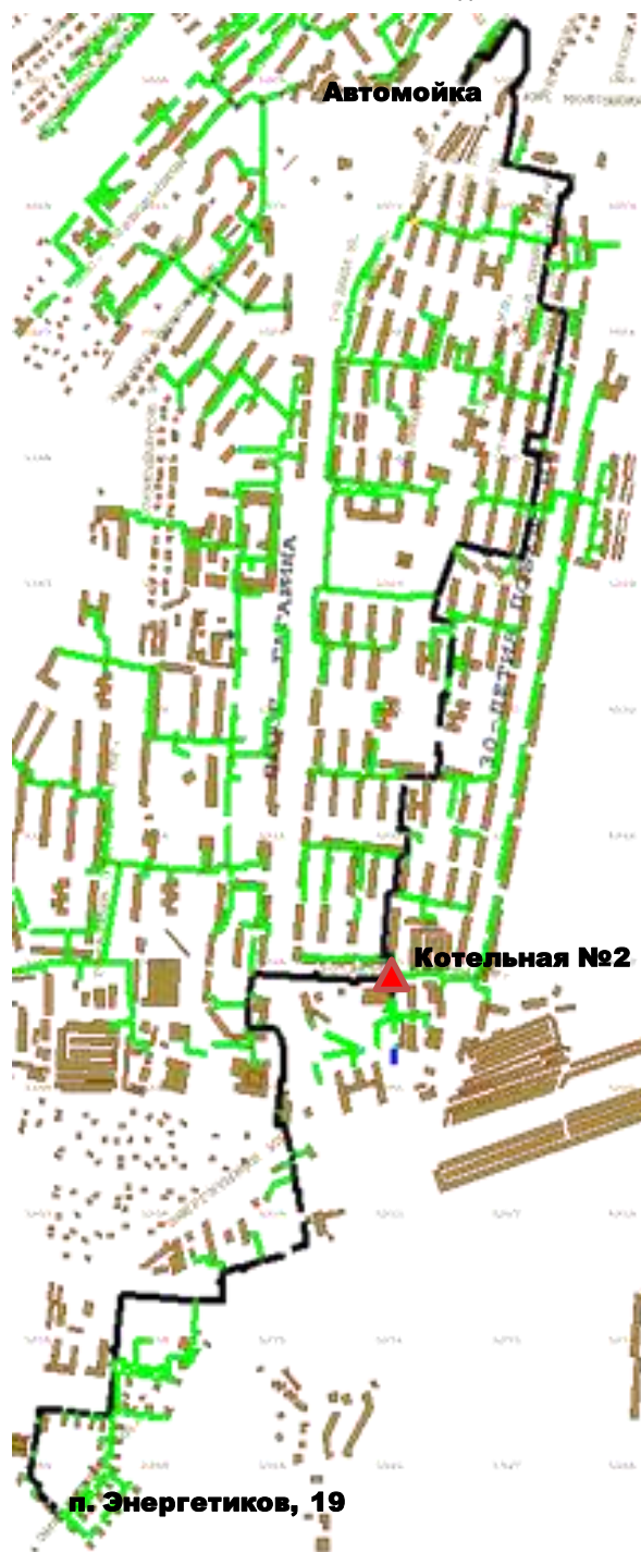
Рисунок 1.7 Пути для расчёта вероятности безотказной работы тепловых сетей от котельной № 2
